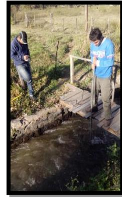
Figura 7: Uso del molinete Hidrométrico en canales que presentan diferentes formas de sección
