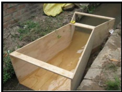
Se lo puede construir de varias medidas y puede ser construido en herrería para que sea portátil o con hormigón para que quede instalado como estación de aforo fija.
