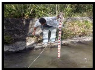
Figura 5: Determinación del área transversal, mediante una regla
