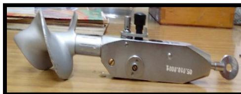
Figura 6: Molinete Hidrométrico de eje horizontal
